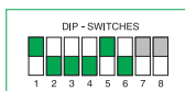
Figura 3: Exemplo de configuração endereço no Art. 1259C para comando com o código actuador 224
